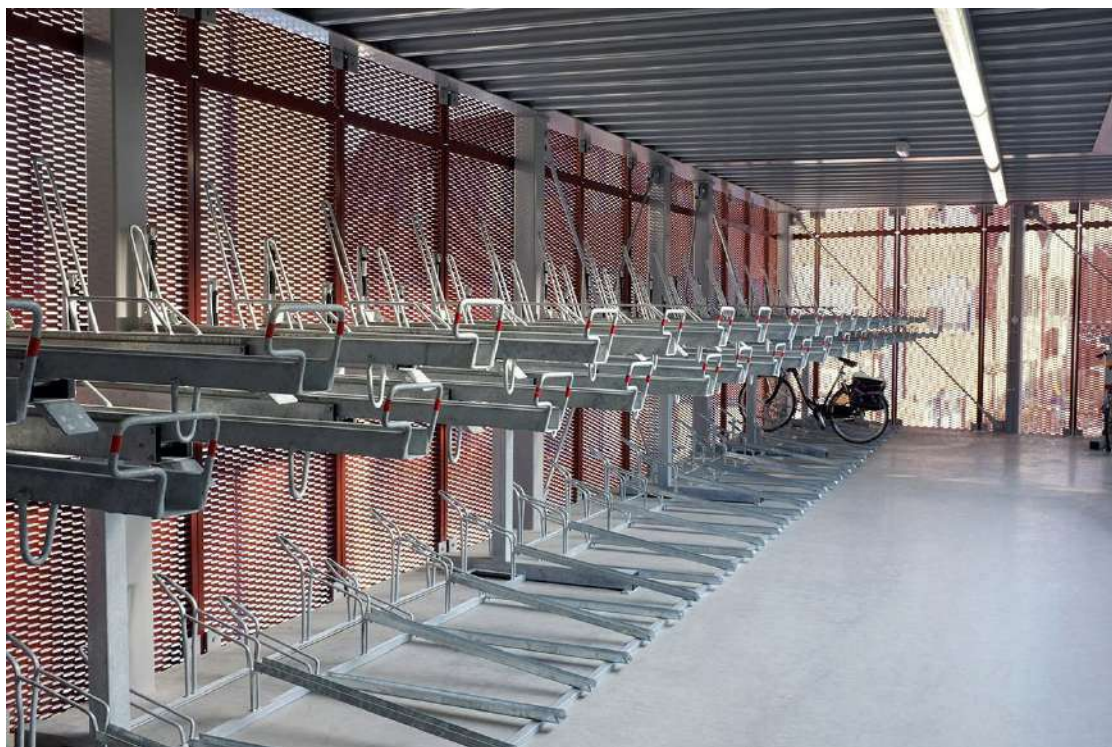
Рисунок 4.21.6 – Двухуровневая велосипедная парковка
