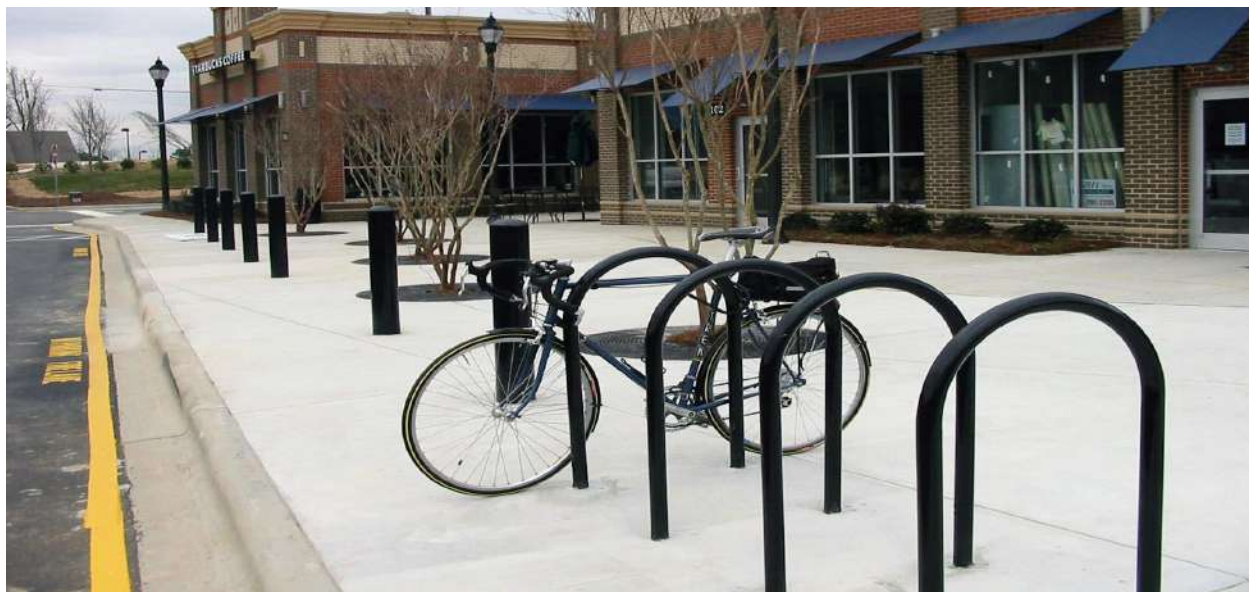
Рисунок 4.21.2 – Парковка велосипеда по типу «стойка»
