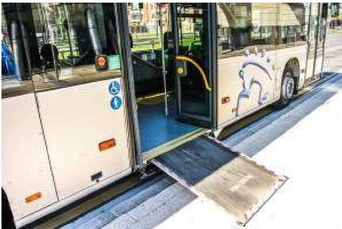
Рисунок 4.19.1 – Автоматический выдвижной пандус для инвалидов
