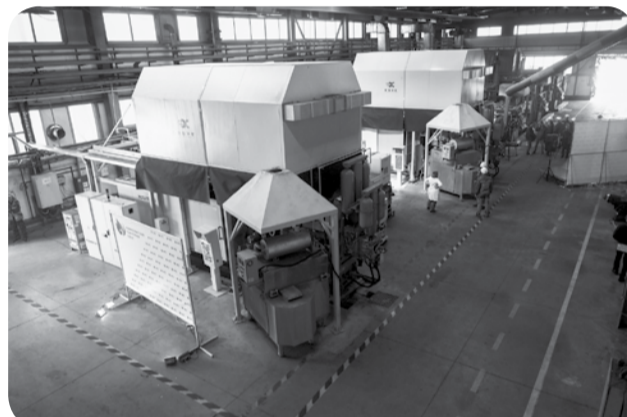
Новая линия завода по производству алюминиевых радиаторов в г. Невинномыске
