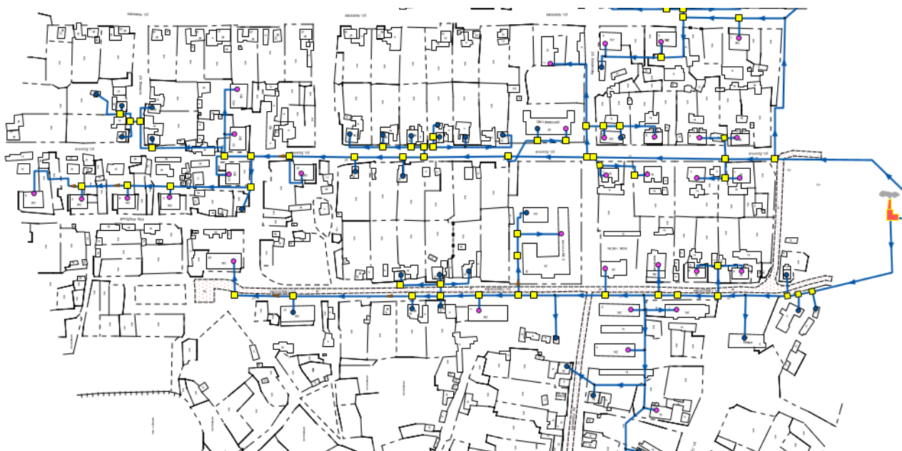
Рисунок 17. Зоны действия котельной «п. Покровск-Уральский», ИНЗД - 3
