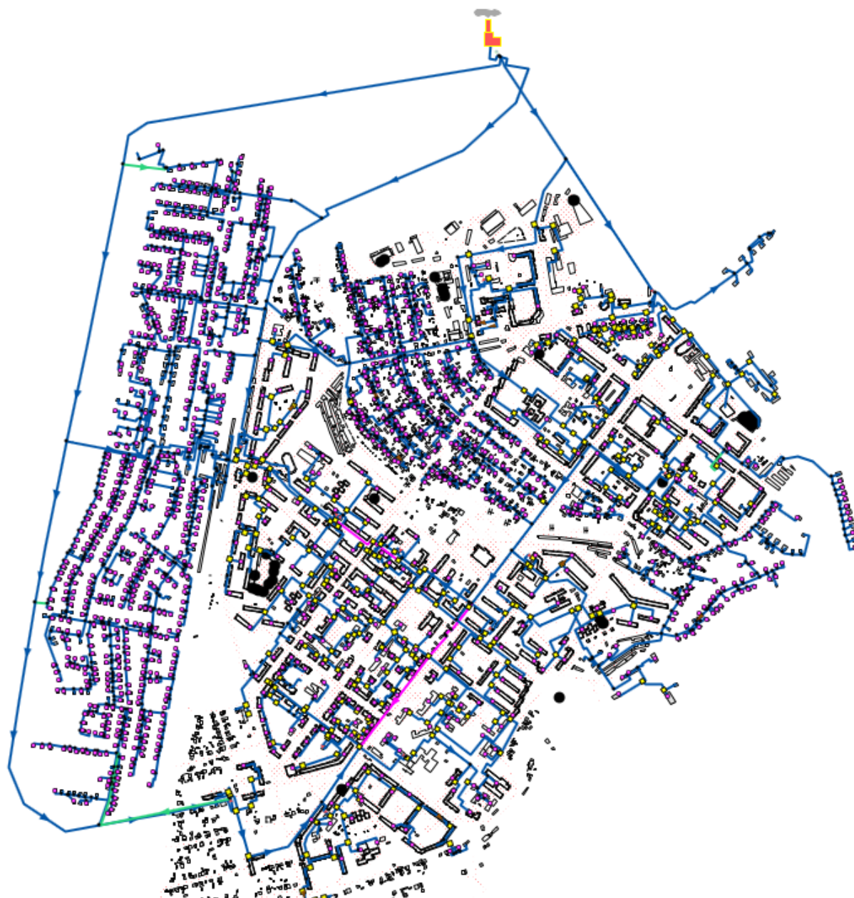
Рисунок 13. Зоны действия источника тепловой энергии Центральной котельной, г. Североуральск, ИНЗД - 1
