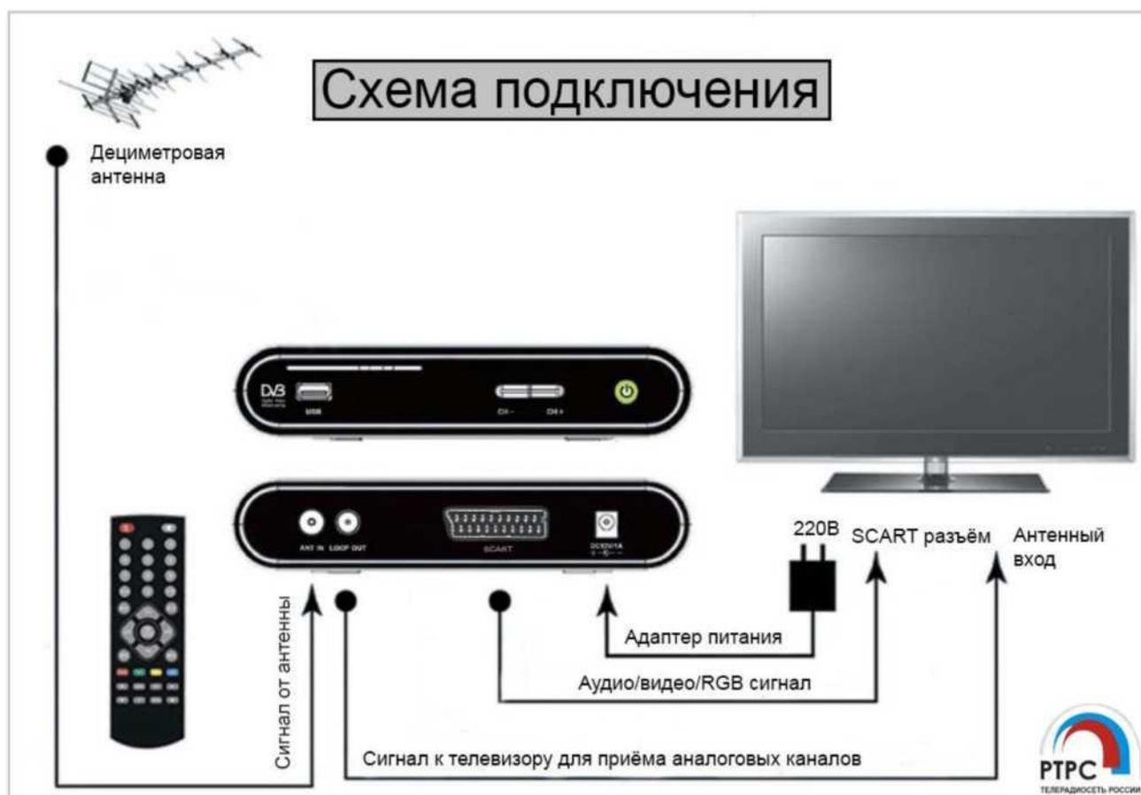
Для этого вам потребуются: телевизор с SCART разъёмом, цифровой ресивер с разъёмом SCART, антенна для приёма ТВ сигнала дециметрового диапазона, соединительные провода. После выполнения данных требований и нужных соединений выберите в телевизоре тип входа AV и произведите автоматический поиск каналов в ресивере согласно инструкции к ресиверу.
