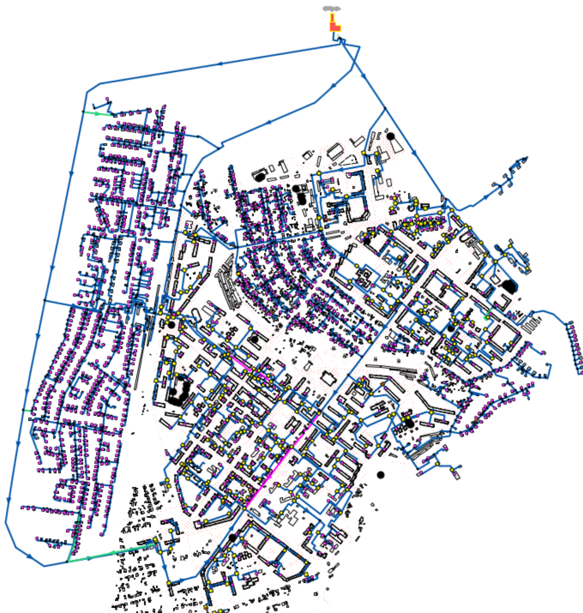
Рисунок 13. Зоны действия источника тепловой энергии Центральной котельной, г. Североуральск, ИИЗД - 1
