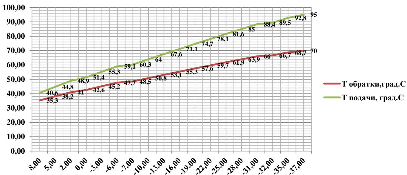
Рисунок 3. Температурный график поселковых котельных
