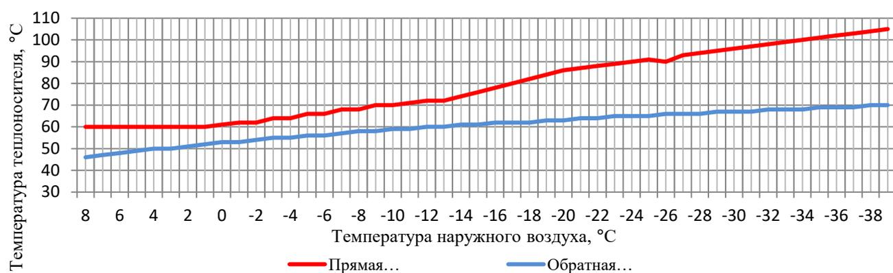
Рисунок 2. Температурный график котельной «Центральная»
