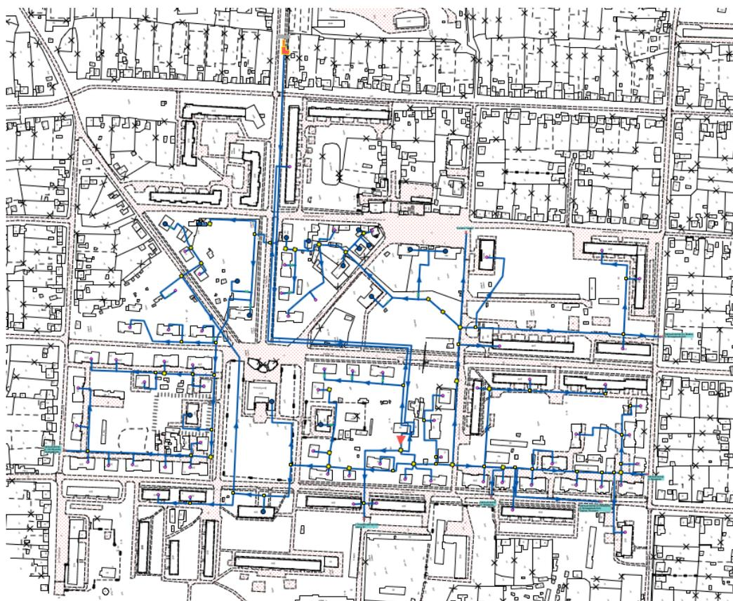
Рисунок 15. Зоны действия источника тепловой энергии котельной «Центральная»,
