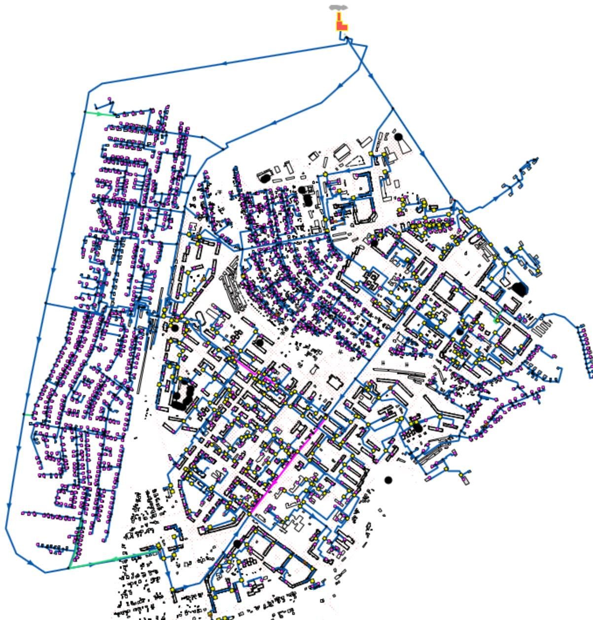
Рисунок 13. Зоны действия источника тепловой энергии котельной «Центральная», г. Североуральск, ИНЗД - 1
