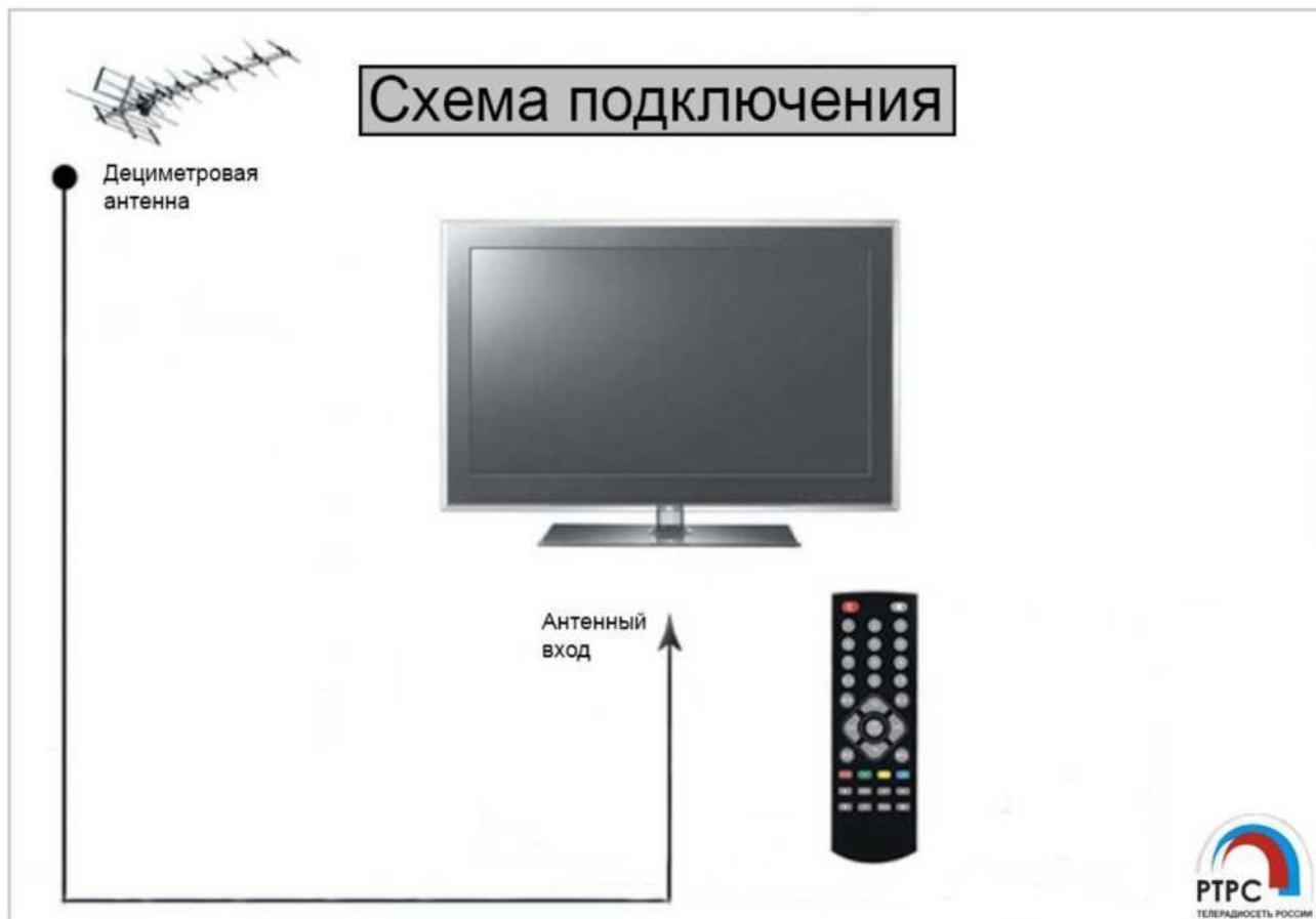
Для этого вам потребуется сам телевизор, антenna для приёма ТВ сигнала дециметрового диапазона и соединительный ВЧ кабель. После выполнения данных требований и нужных соединений выберите в меню телевизора источник изображения «Цифровое эфирное телевидение DVB-T2» и выполните автоматический поиск каналов согласно инструкции к телевизору.
