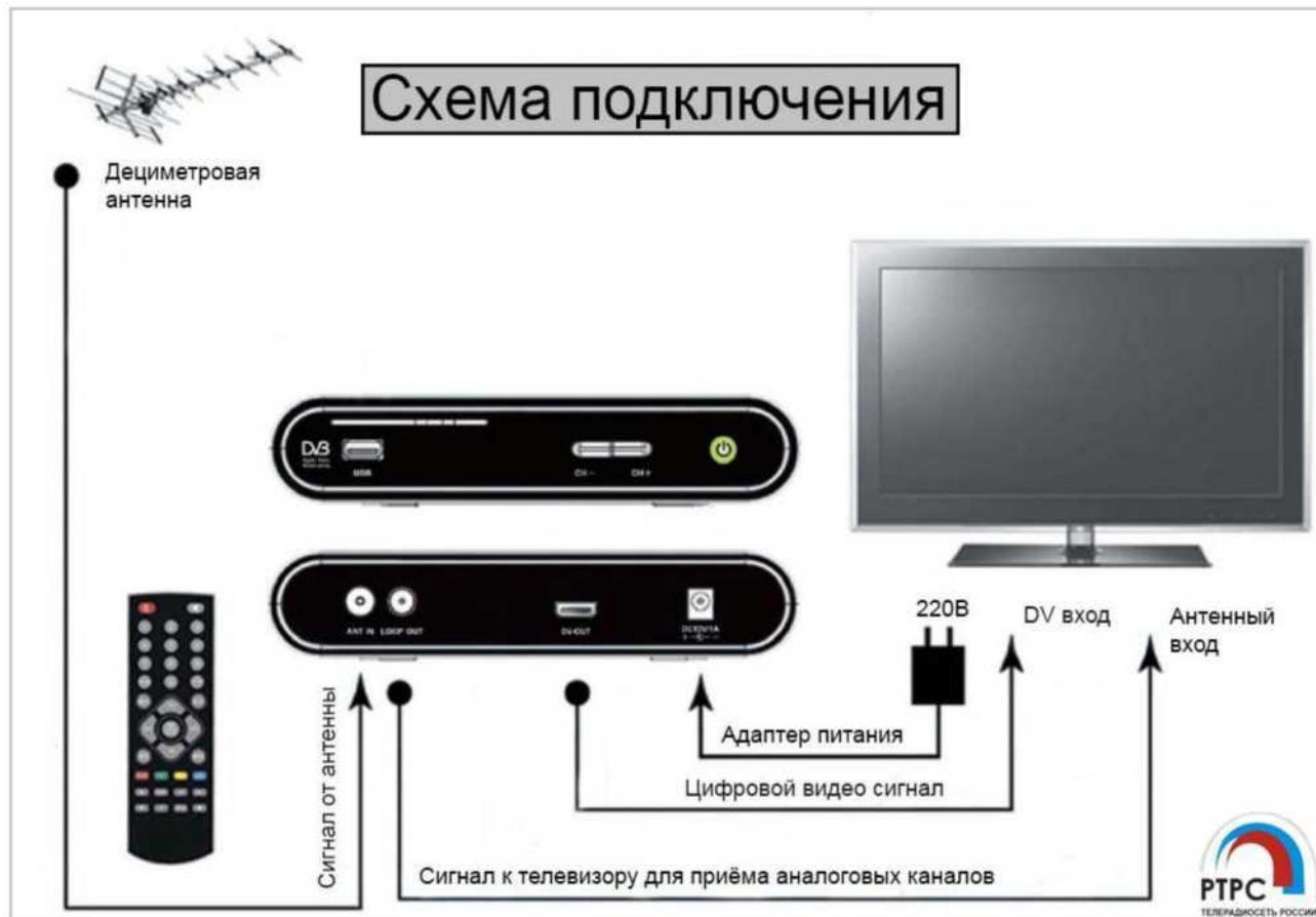
Для этого вам потребуются: цифровой видео вход DV, цифровой ресивер с разъёмом DV, антенна для приёма ТВ сигнала дециметрового диапазона, соединительные провода. После выполнения данных требований и нужных соединений выберите в телевизоре тип входа DV и произведите автоматический поиск каналов в ресивере согласно инструкции к ресиверу.
