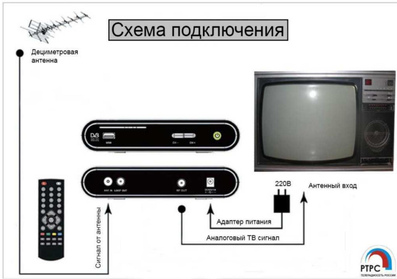
Для этого вам потребуются: любой телевизор, цифровой ресивер с радиочастотным выходом, антенна для приёма ТВ сигнала дециметрового диапазона, соединительные провода. После выполнения данных требований произведите автоматический поиск каналов в ресивере согласно инструкции к ресиверу, автоматическим поиском каналов (если он имеется) выполните поиск канала с ресивера. При этом
