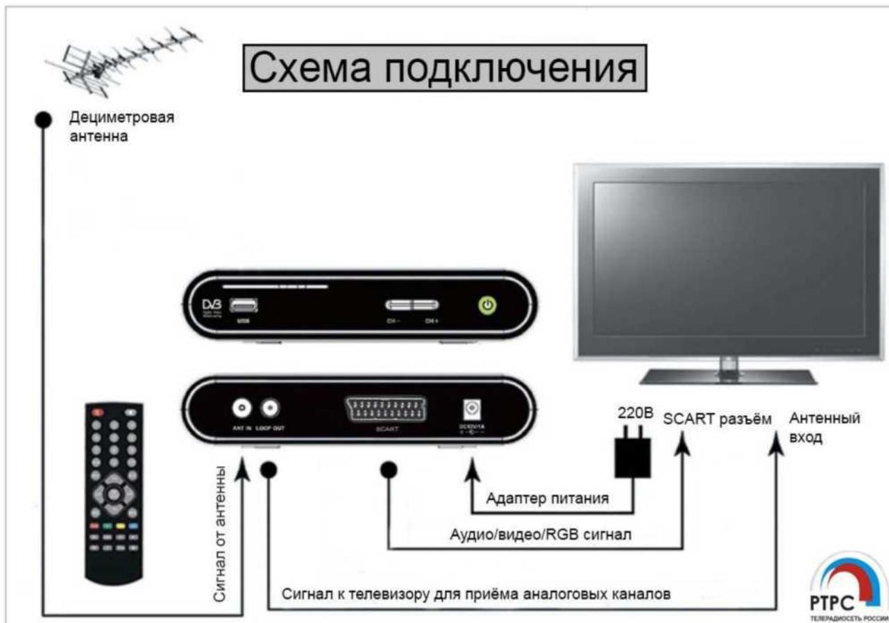
Для этого вам потребуются: телевизор с SCART разъёмом, цифровой ресивер с разъёмом SCART, антenna для приёма ТВ сигнала дециметрового диапазона, соединительные провода. После выполнения данных требований и нужных соединений выберите в телевизоре тип входа AV и произведите автоматический поиск каналов в ресивере согласно инструкции к ресиверу.
