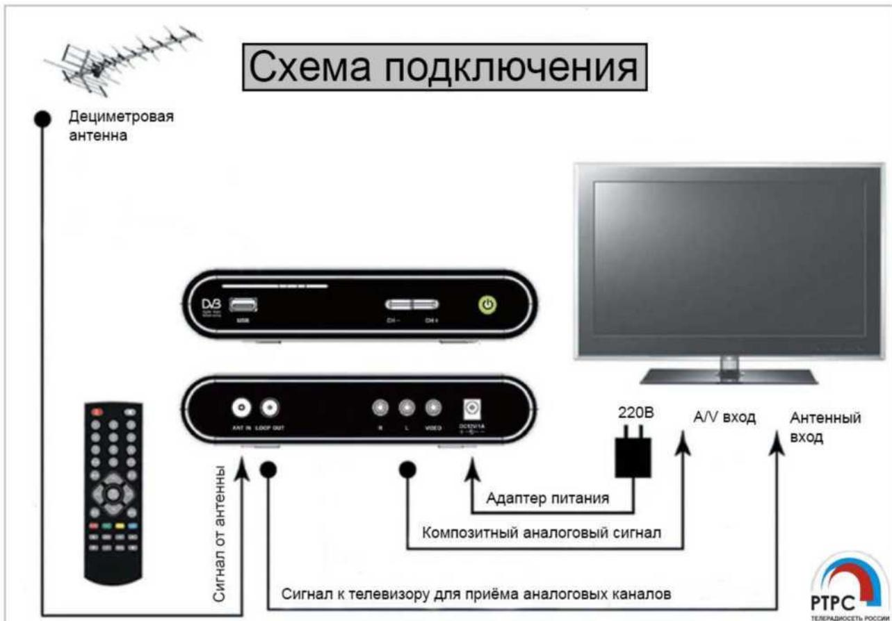
Для этого вам потребуются: телевизор со входом 3RCA, цифровой ресивер с выходом 3RCA, антенна для приёма ТВ сигнала дециметрового диапазона, соединительные провода. После выполнения данных требований и нужных соединений выберите в телевизоре тип входа AV и произведите автоматический поиск каналов в ресивере согласно инструкции к ресиверу.
