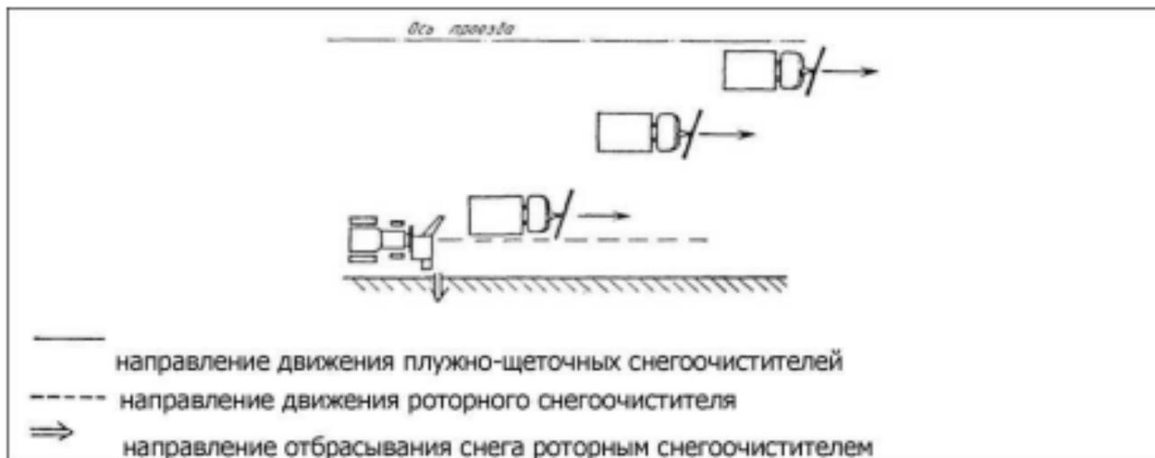
Рисунок 8– схема расчистки проезжей части улиц колонной плужно-щёточных снегоочистителей и перекидывание снега роторным снегоочистителем.
