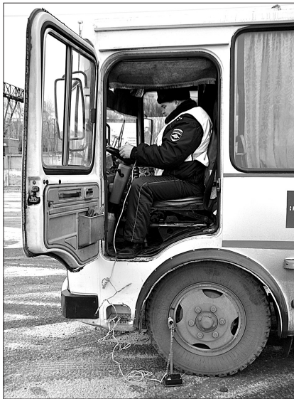
Государственный инспектор по безопасности дорожного движения О. Н. Петрищев проверяет суммарный люфт рулевого управления.
