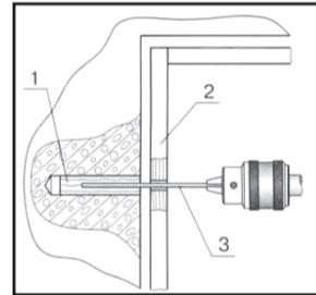
Проблему решили просто – зажали в патрон дрели электрод 3 – 2,5 мм и разработали им отверстия в пробках. Саморезы после этого ввернули без затруднений.
