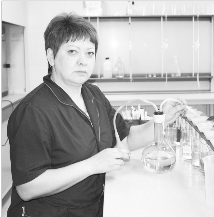
Лаборант химического анализа Т.А. ШАБАЕВА определяет процентное содержание серы в известняке.
