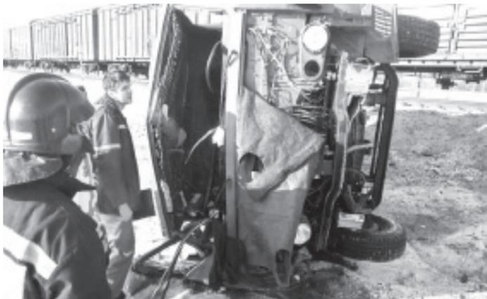
В результате аварии на маневровом локомотиве пробит топливный бак, движение на данном участке было парализовано.
