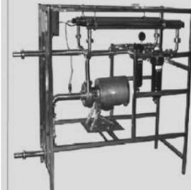
Комплекс КООМ предназначен для очистки цельного молока от механических примесей и биологических загрязнений (проявлений мастита, лейкоза, слизи, денатурированных белков) фильтрацией в дисковом фильтре тонкой очистки с последующим ультрафиолетовым обеззараживанием в установке бактерицидной обработки молока (УБО-М).
