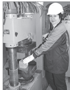
В лаборатории бетон испытывают на прочность
