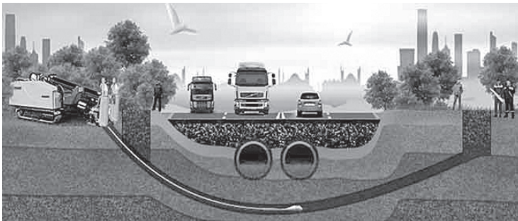
Рисунок 11.7. Выполнение магистральных инженерных сетей в подземном исполнении методом «прокола»
