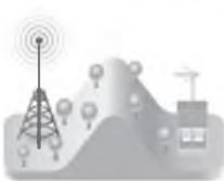
Рельеф местности (сложные условия приема возникают в низинах, в районах с сильно пересеченным рельефом местности, непосредственно за лесными массивами и железнодорожными насыпями)
