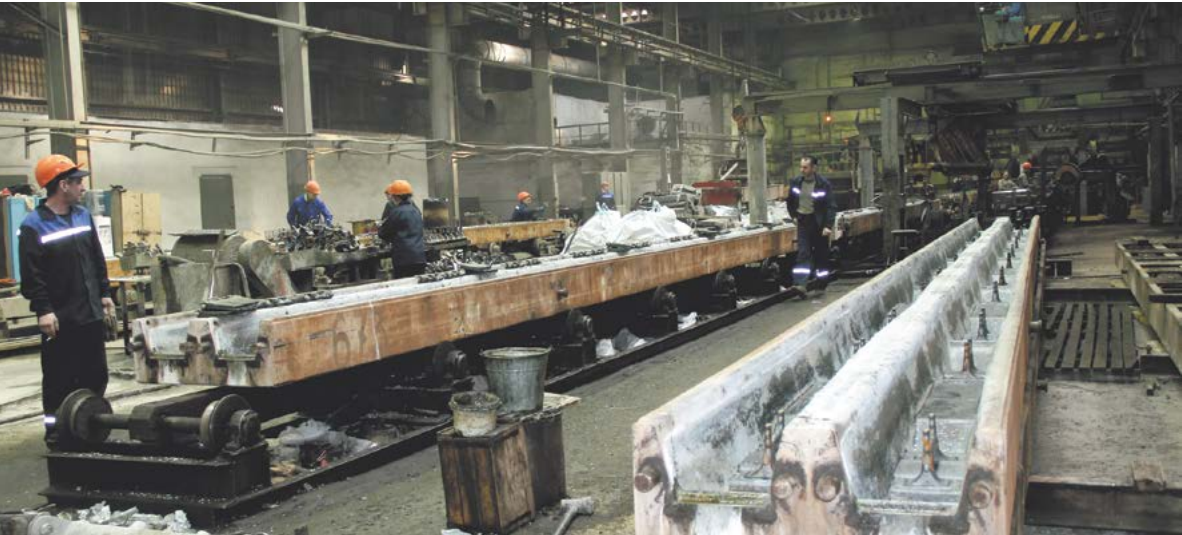
Линии по производству шпал
