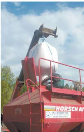
«Мониту» (погрузчик) загружает «Хорш» (посевной комплекс)
