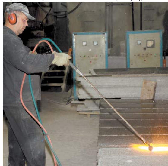
Алексей Старцев проводит термообработку гранита
