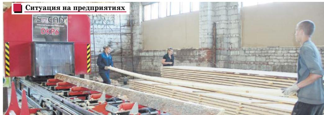
В работе лесопильный станок углового пиления
