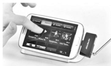
Просмотр телепередач на экране телефона или планшета без подключения к сети возможен благодаря специальной ресиверу, которые подключаются к устройству через microUSB-порт. При этом качество изображения на дисплее смартфона с OLED-матрицей выше, чем на LCD-экране телевизора.
