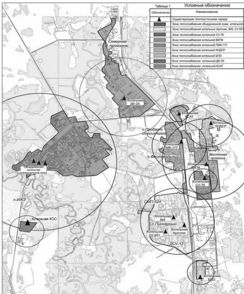
Рисунок 2. Радиус эффективного теплоснабжения
