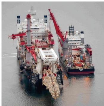
Судно «Solitaire» с динамическим позиционированием длиной 300 м и шириной 41 метр принадлежит компании Allseas и будет выполнять работы по трубоукладке круглосуточно и без выходных. На борту судна работает до 420 человек. При безъякорном позиционировании судна с морским дном контактирует только укладываемый газопровод, что позволяет свести к минимуму воздействие на окружающую среду и судоходство.
