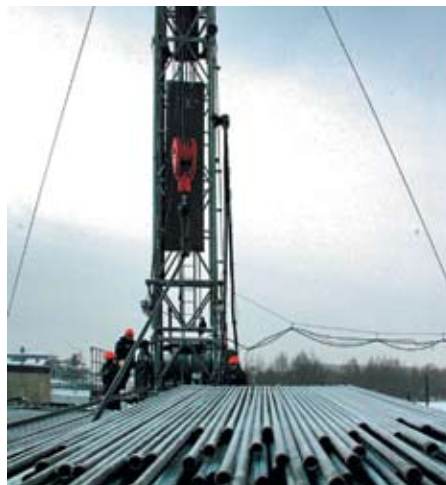
Бурение скважин малого диаметра
