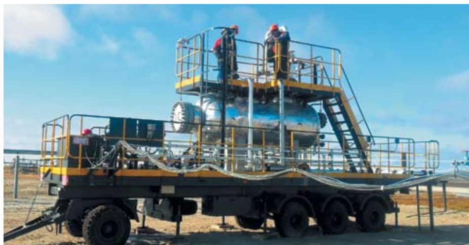
Сепаратор для исследования скважин в шлейф без выпуска и сжигания газа
