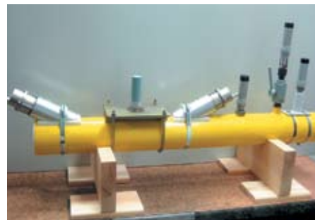
Беспроводные датчики на трубе
