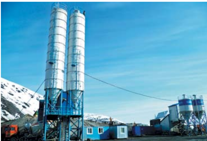
Бетоносмесительный комплекс
