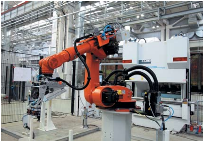
Ячейка линии роботизированной сварки (Kuka Systems GmbH, Германия)
