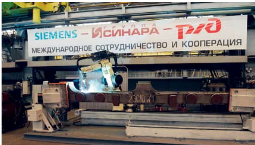
Сварка рамы для нового электровоза «ГРАНИТ» серии 2ЭС10
