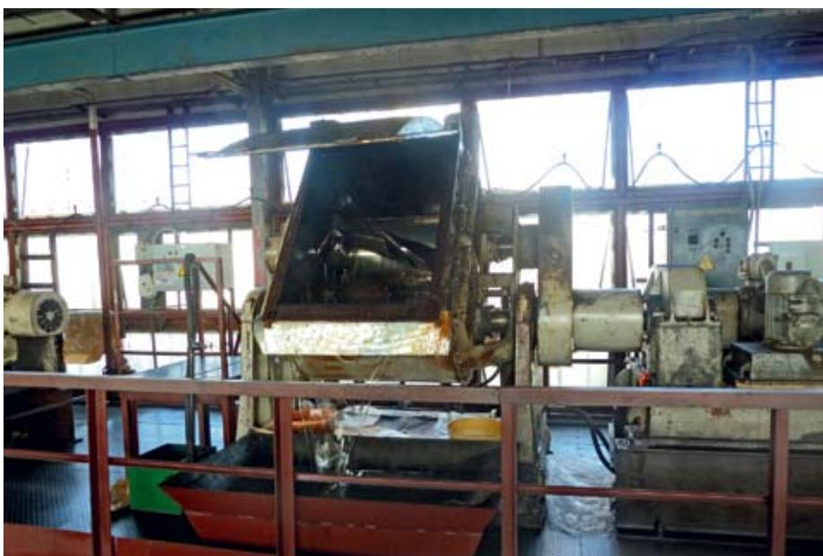
Выгрузка готового герметика из смесителя
