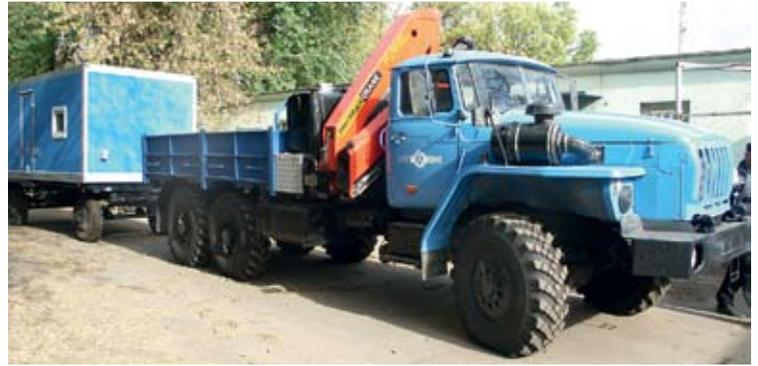
Автомобили для перевозки натяжных механизмов комплекса для замены грозотроса под напряжением (шасси а/м «Урал-4320», пассажирский отсек на прицепе, грузовой отсек, кран-манипулятор гидравлический (КМУ) типа PALFINGER PK 12000 за кузовом)
