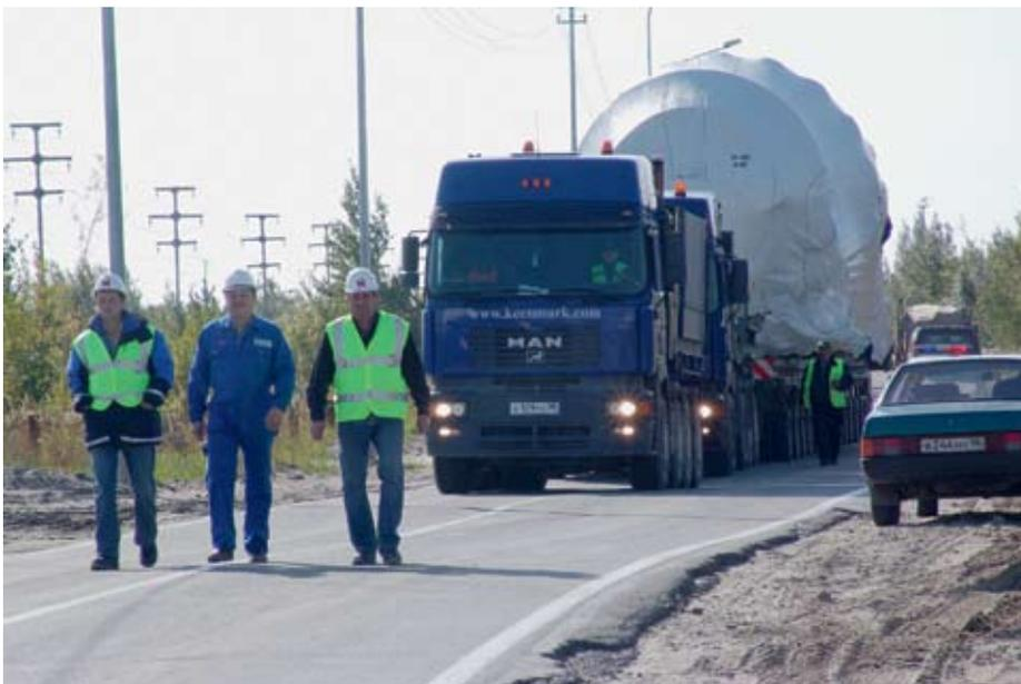
Транспортировка газовой турбины весом 279 тонн
