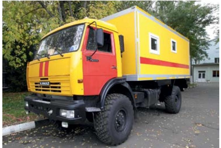
Автомобили для выполнения аварийно-восстановительных работ МПЗ-АВР, МПЗ-АРМ для доставки бригады специалистов с комплектом автономно работающего оборудования и необходимым оборудованием к месту разворачивания работ по устранению аварии или проведения технического обслуживания объекта на линиях электропередачи
