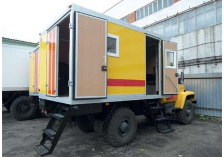
Автомобили оперативно-выездной бригады МПЗ-ОВБ для выполнения основных эксплуатационно-ремонтных работ, ликвидации технологических нарушений в электрических сетях, обслуживания электроустановок, выполнения работ по технологическому присоединению потребителей к сетям
