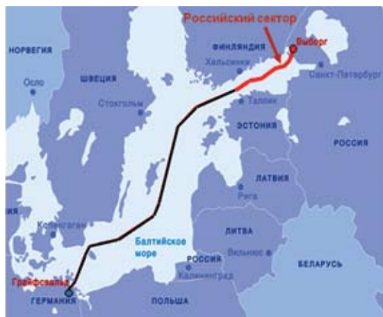
Схема газопровода «Северный поток» (Nord Stream)
