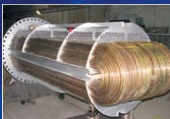
Трубный пучок подогревателя ПН-300
