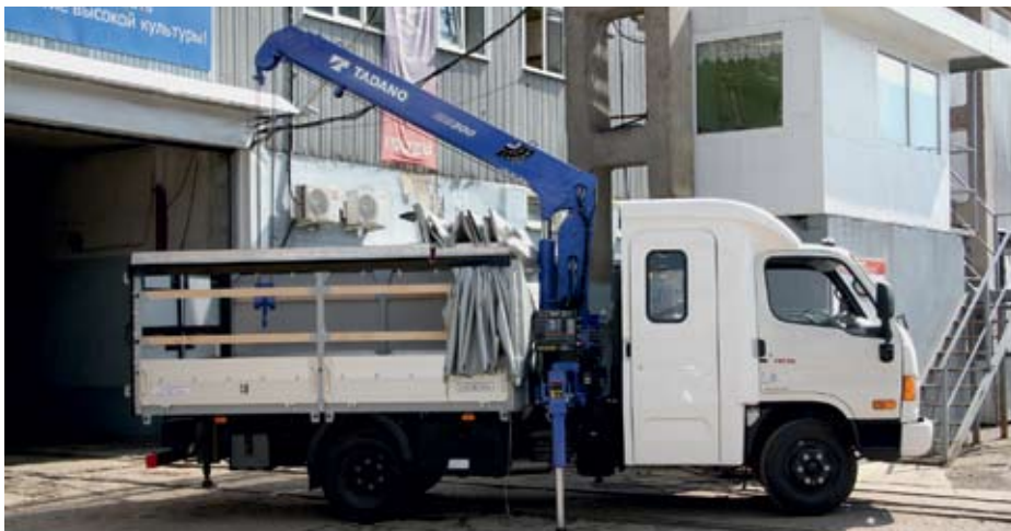
Hyundai-78 с двухрядной кабиной и гидроманипулятором Tadano TM-ZE 303 HS
