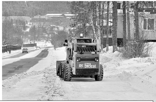
С помощью специальной техники осуществляется посыпка внутригородских дорог противогололедными материалами
