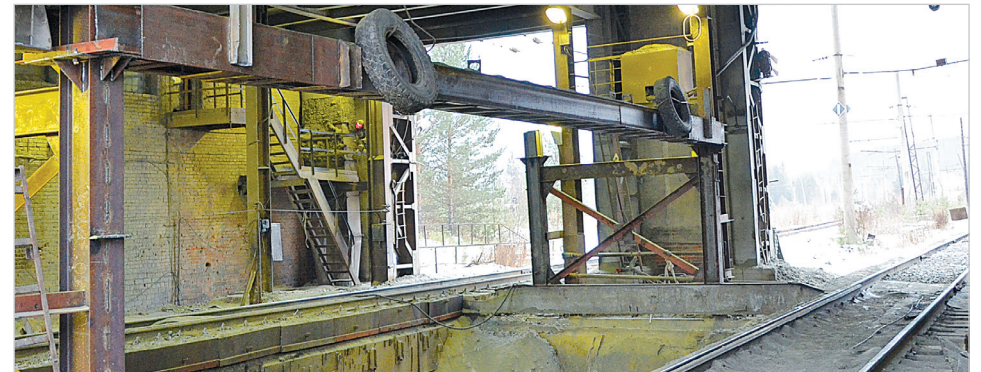
Специальное устройство, которое позволит избежать падения думпкаров в дробилку
