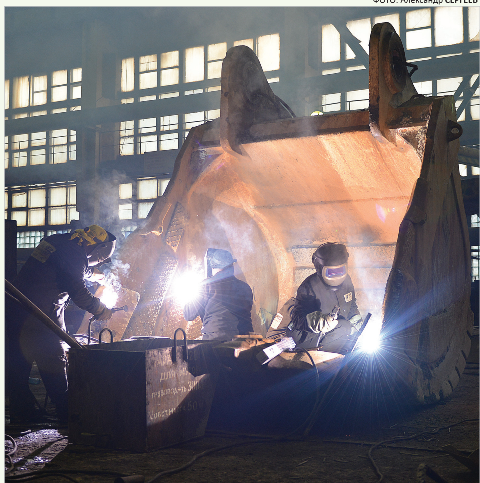
Сварщики РЭМЦ ведут наплавку ковша экскаватора Komatsu
