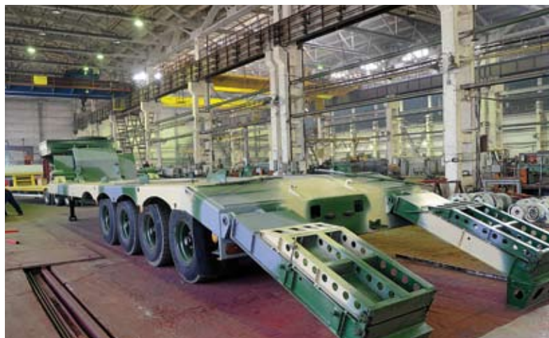
Челябинский полуприцеп для перевозки танковой техники в сборочном цехе
