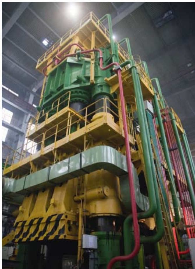
Модернизированный вертикальный штамповочный пресс усилием 300 МН
