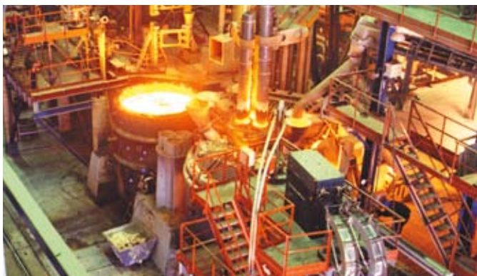
Двухпозиционный агрегат ковш-печь емкостью 160 тонн, разработанный НТ ЗАО «Аконт» для кислородно-конверторного цеха Челябинского металлургического комбината
