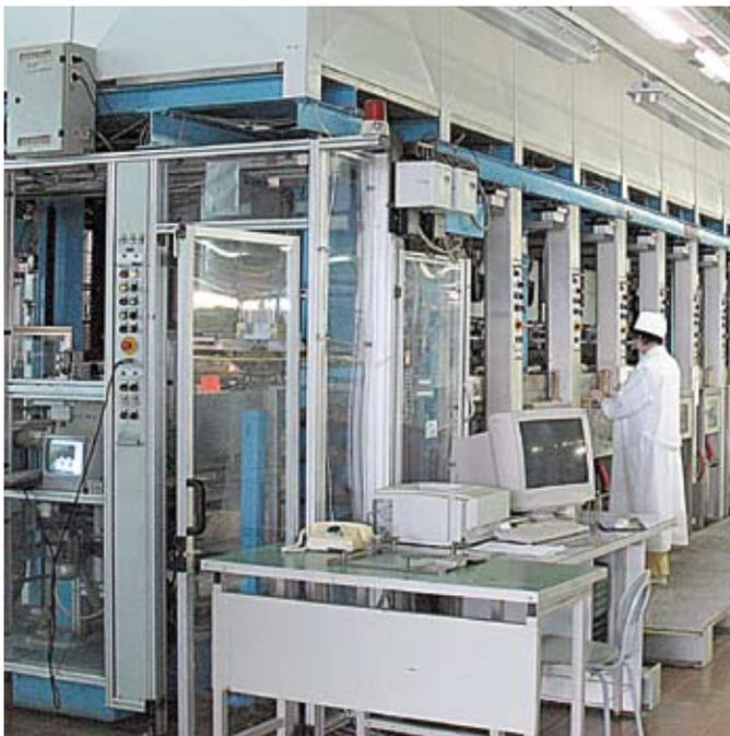
Автоматизированная линия по производству чип-конденсаторов
