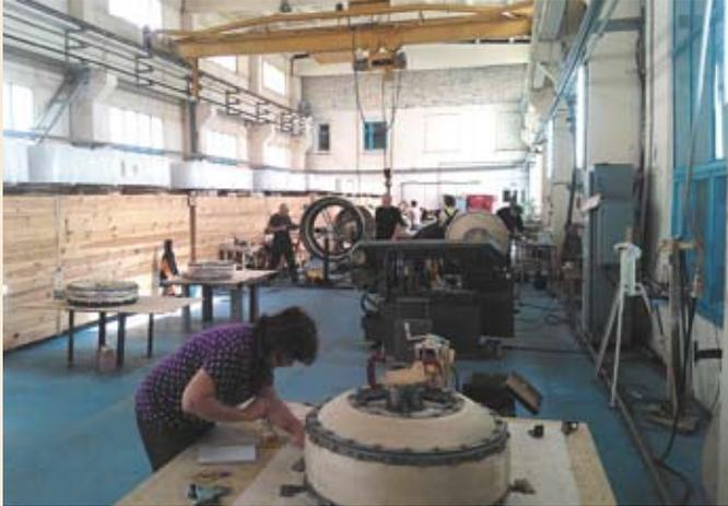
В цехе сборки гермопроходок натриевых трубопроводов
