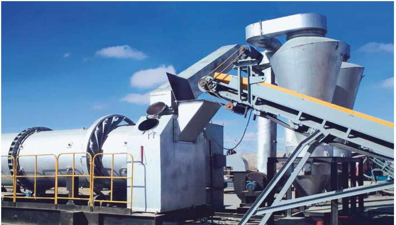
Механизированная линия термической переработки шлама
