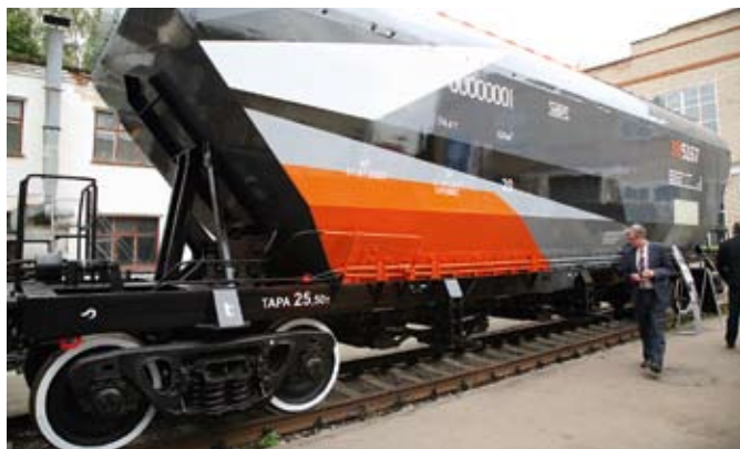
Вагон-хоппер для минеральных удобрений с кузовом, полностью изготовленным из композиционных материалов
