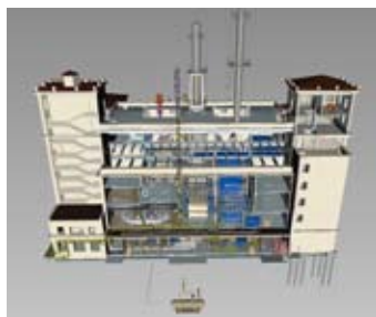
Реконструкция «Теплоцентральной» НИИ «МЭИ». Комплексная 3D-модель проектируемого объекта
