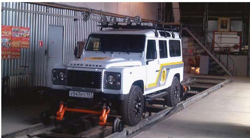
Специальный подвижной состав на комбинированном ходу, оборудованный БЛОК-КХ
