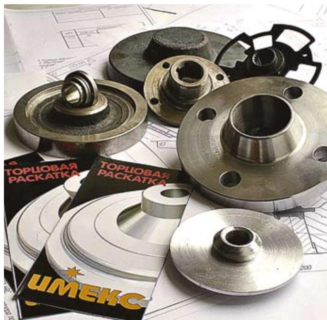
Стальные заготовки, модернизированные методом торцовой раскатки
