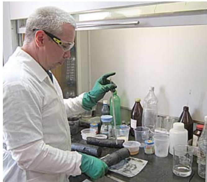
Лабораторные испытания полимерного анодного заземлителя
