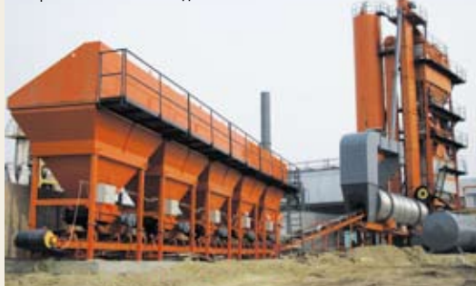
Асфальто-бетонный завод КА-160
