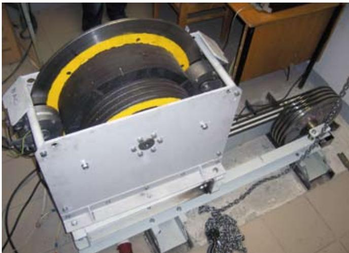
Электропривод лифта безредукторный с вентильным электродвигателем
