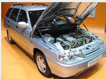
Электромобиль «Антэл-2» с генератором «Фотон МВК»
