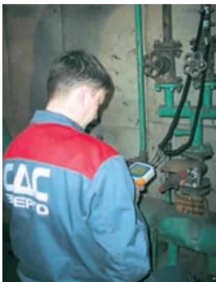
Инструментальные замеры расхода теплоносителя
