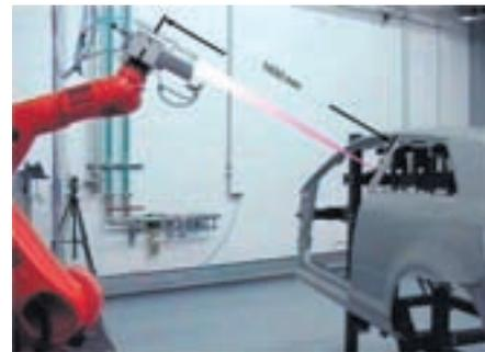
Дистанционная лазерная сварка корпуса автомобиля
