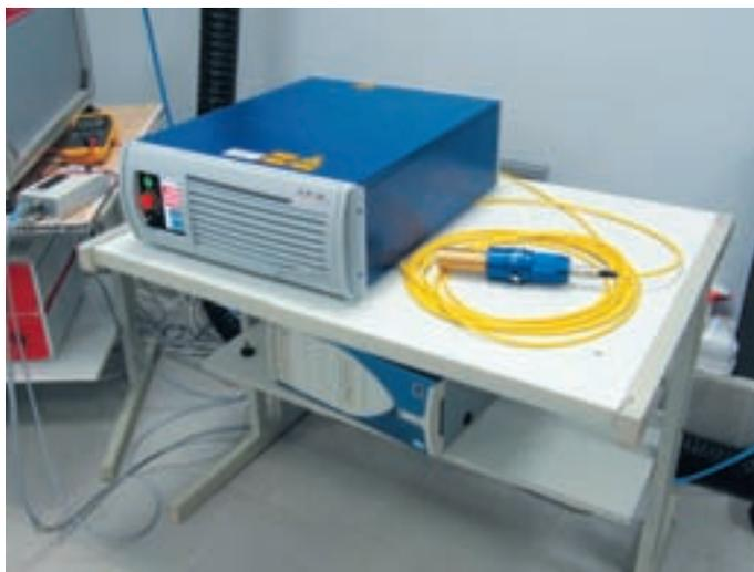
Импульсный волоконный лазер для сварки и резки
