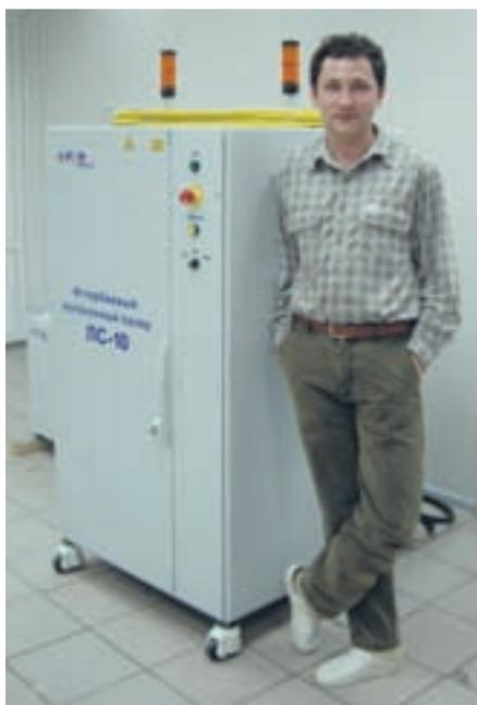
10 кВт промышленный волоконный лазер
