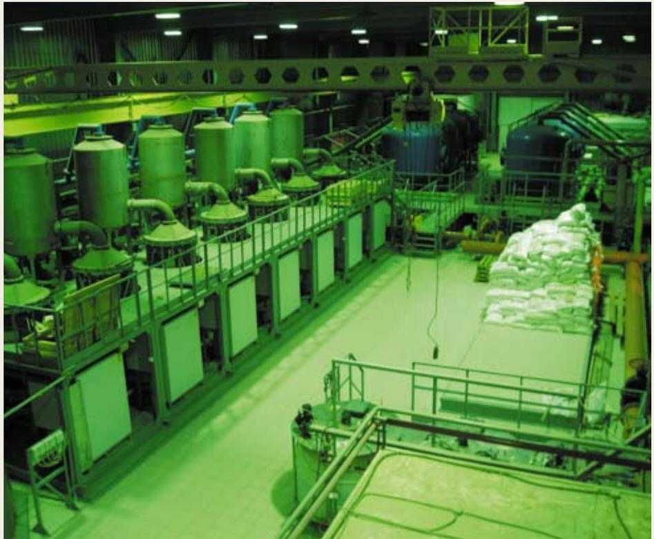
Линия электрокоагуляционных модулей обработки воды на станции «Водопад-8000»
