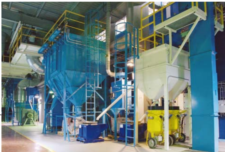
Комплекс пылеочистного оборудования от линии дробеструйной обработки
