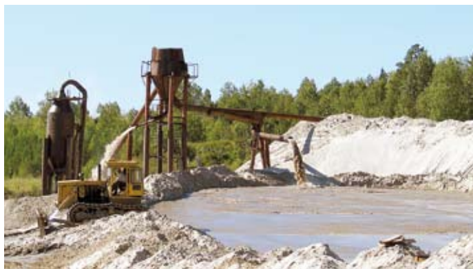
Гидромеханизированная разработка месторождения песчано-гравийной смеси с использованием специального обогатительного оборудования (конического грохота) для отмыва мелких частиц и разделения ПГС на песок и гравий в Томской области
