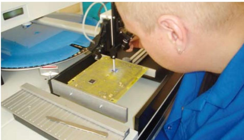
Производственно-технологическое отделение. Полуавтомат установки компонентов
