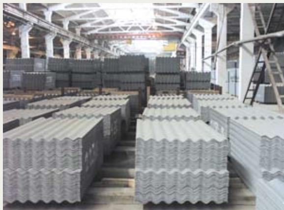
**Шифер — один из самых универсальных кровельных материалов. Недорогой и простой в монтаже, он обладает высокой морозостойкостью, пожаробезопасностью, устойчивостью к неблагоприятным воздействиям внешней среды, отличными термоизоляционными свойствами.**
