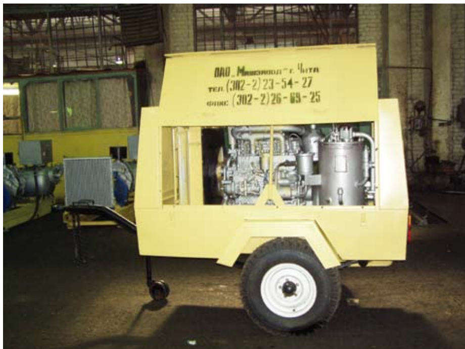
Компрессорная станция ПВ6
