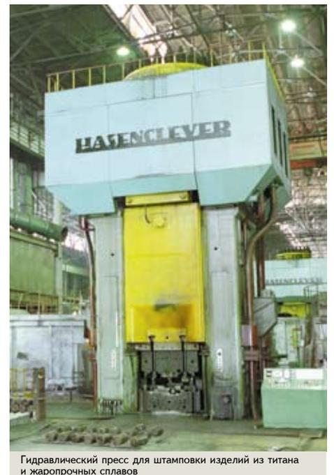
Гидравлический пресс для штамповки изделий из титана и жаропрочных сплавов
