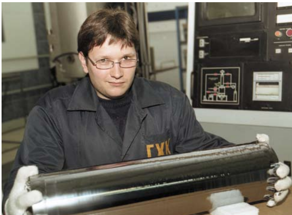
Первый «слиток» монокремния, выращенный из собственного поликремния
