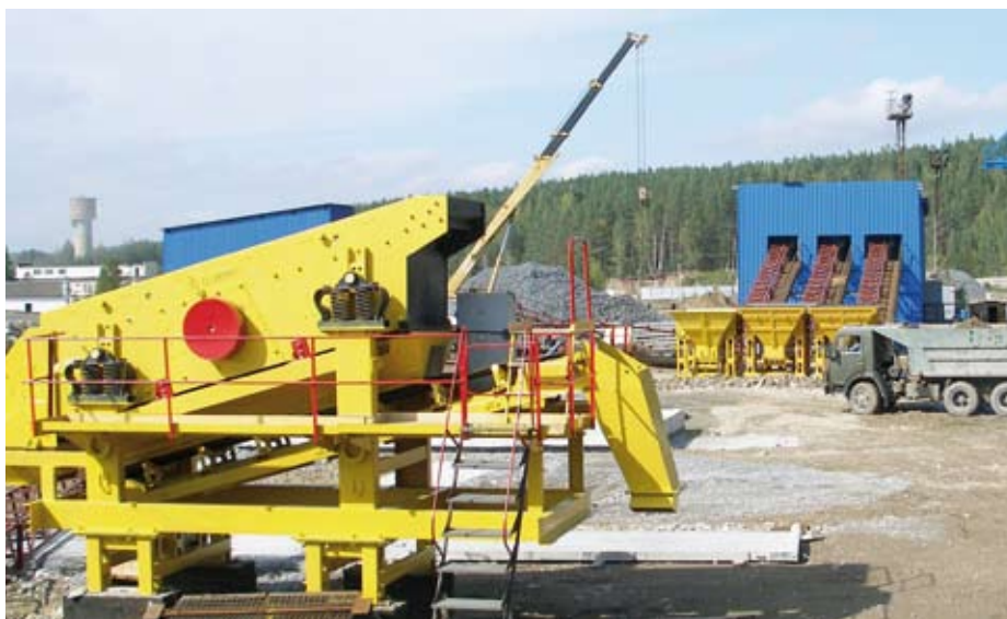
Станция разделительная — грохот
