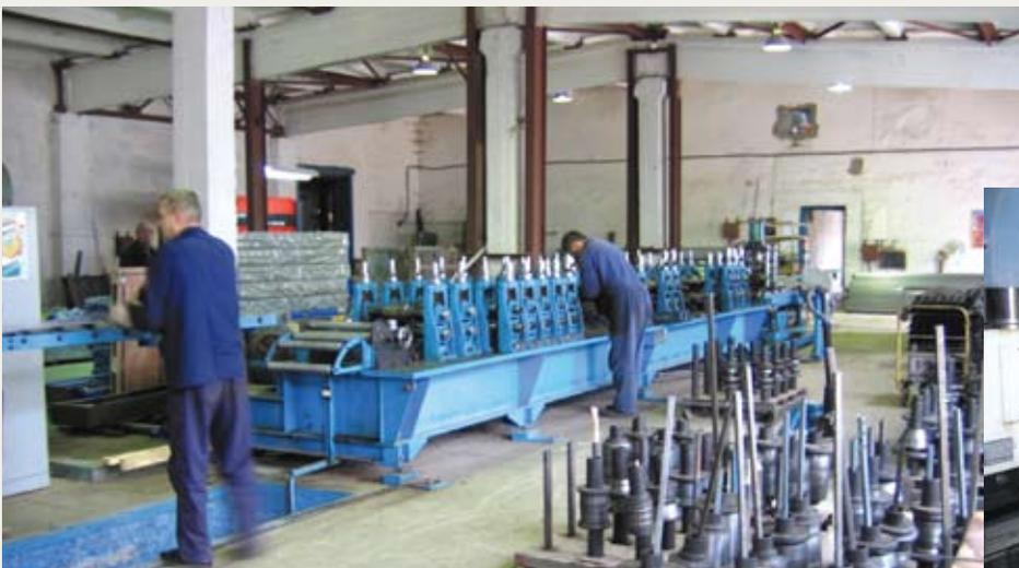
Прокатная автоматизированная линия холодного профилирования
